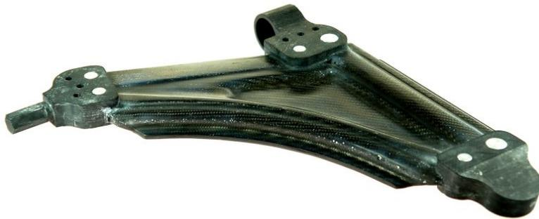
Prototyp eines Faserverbundquerlenkers.
